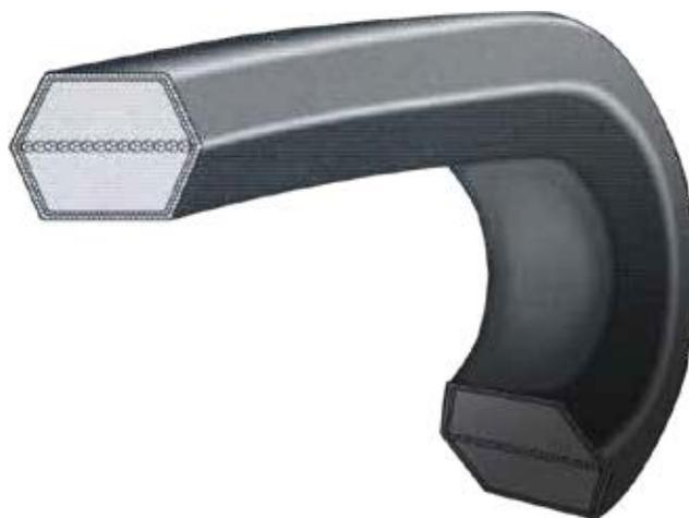
Il profilo trapezoidale doppio della cinghia è adatto per trasmissioni con un'inclinazione a S e nel quale entrambi i lati della cinghia devono essere usati per trasmettere potenza. Questo tipo di trasmissione è comunemente usata nelle macchine agricole e in applicazioni industriali speciali.
